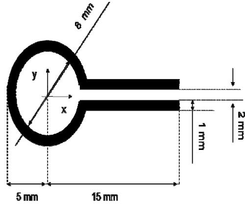
Fig. 1. Loop antenna.
