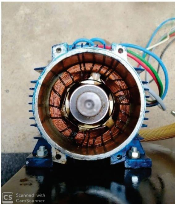
Fig. 15. ISRM prototype.
