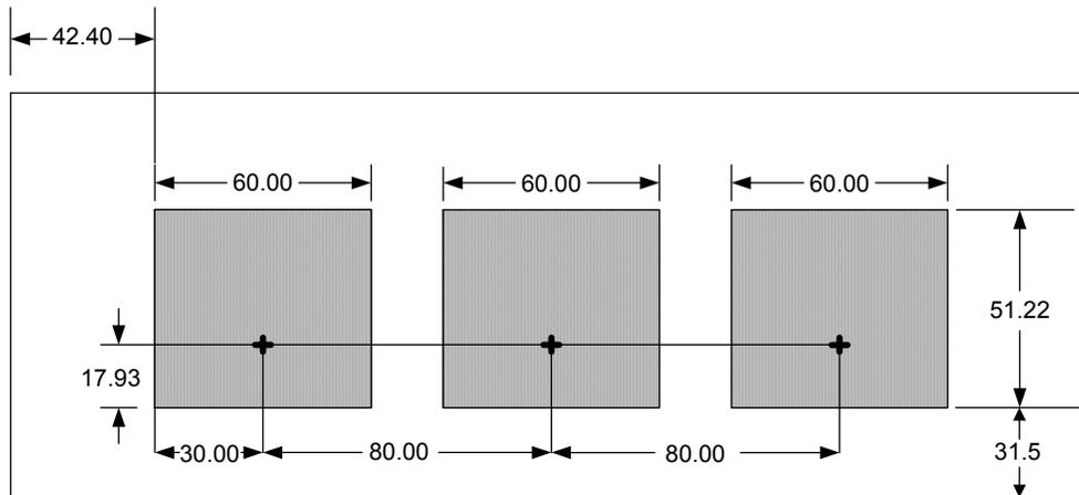
**Fig. 3** 3-element patch array
